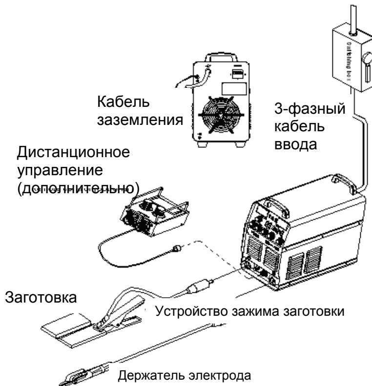
Рисунок 8.2.: Карта-схема установки при сварке ММА покрытым электродом
