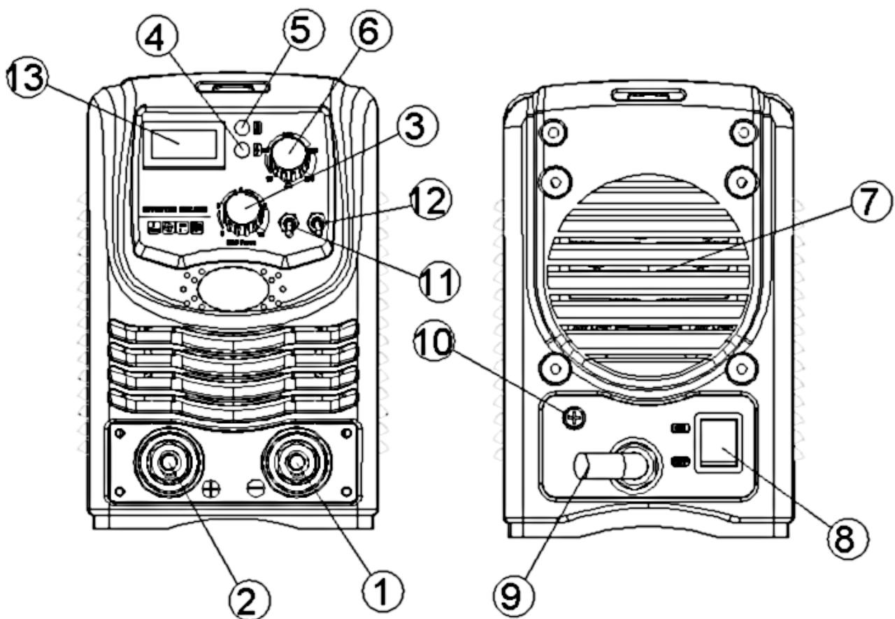
1. Клемма «-», для подключения зажима массы.
