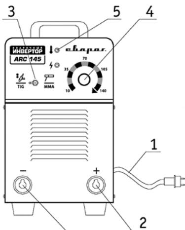
1. Шнур подключения к электросети 220 В/380 В находится на задней панели аппарата.
