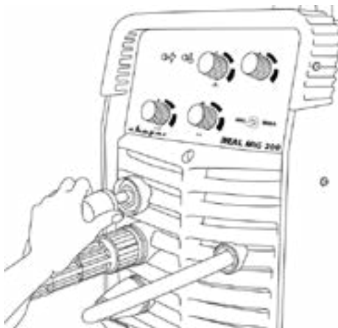
Рис. 7.2. Подключение силового наконечника клеммы заземления.
